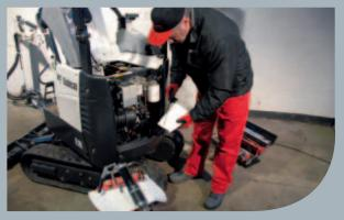
Grâce à un accès facile au moteur et au circuit hydraulique, l'entretien de ces machines s'avère plus simple et apide que jamais.
