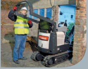
Les deux modèles sont équipés d'un arceau de sécurité TOPS rabattable.
