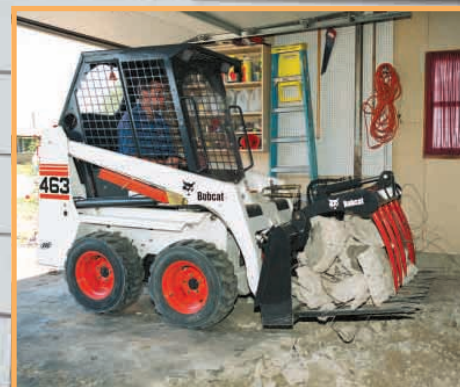
Le système standard d'accrochage BOB-TACH assure un changement rapide et sûr d'accessoires.
