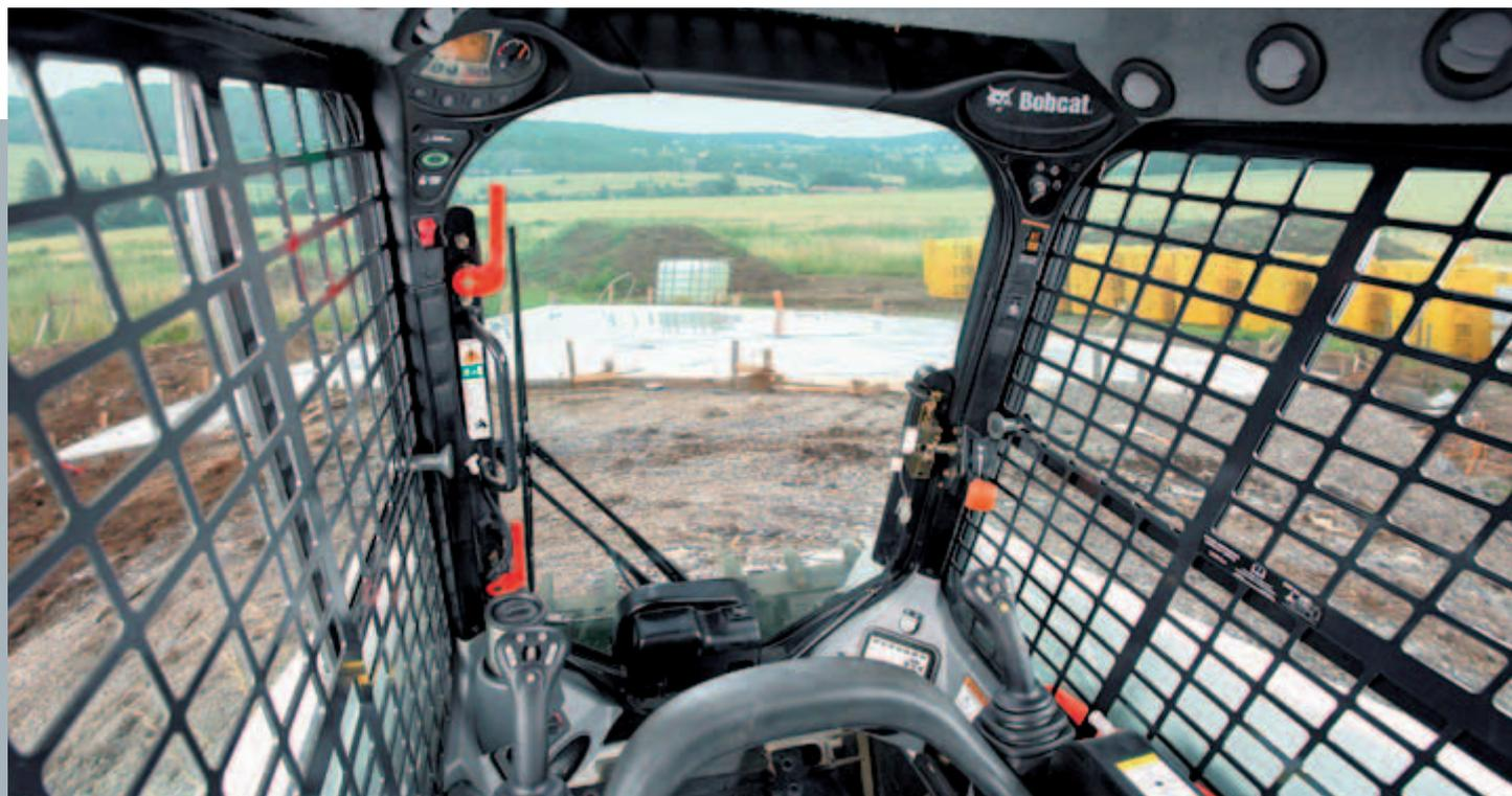
La nouvelle génération de chargeuses Bobcat est équipée d'une cabine pressurisée haut de gamme. Elle comporte un nouveau joint monobloc entourant l'intégralité de la porte et s'insérant dans un logement arrondi spécialement conçu pour empêcher les infiltrations de saleté et de poussière. Les niveaux sonores ont été réduits de plus de 60 % pour améliorer le confort de l'opérateur.
