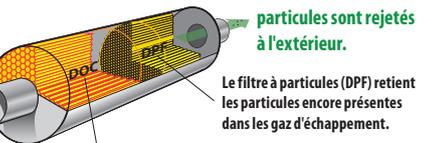
L'oxydeur catalytique (DOC) réagit au contact des gaz d'échappement et transforme les particules en substances inoffensives.
